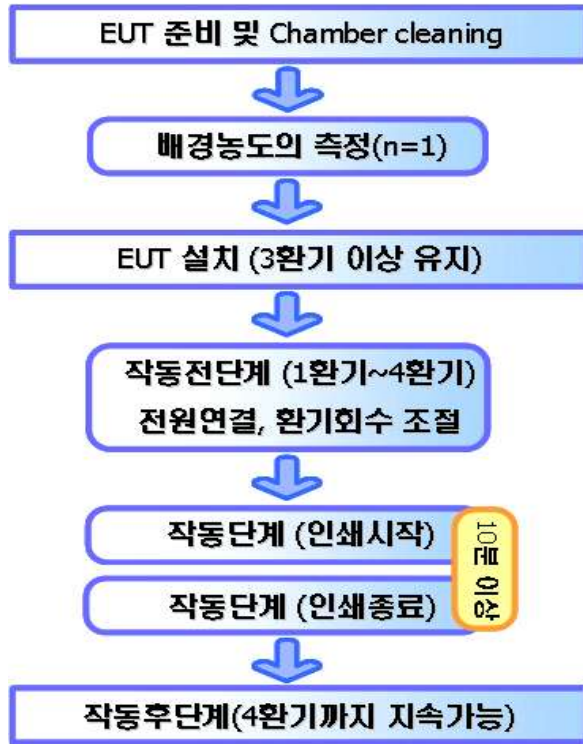
(그림 7) 소모품을 사용하는 제품 방출시험방법
